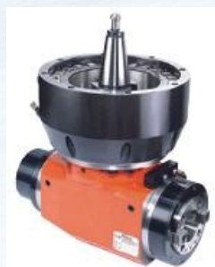
Угловая фрезерная головка VT50/90° с макс. скоростью 3500 об/мин, угловым шагом 5° (АН)
